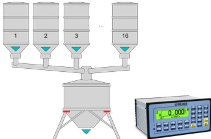
Software applicativo per indicatori di peso 3590EXT e CPWE, per creare sistemi di dosaggio automatico multicomponente e multibilancia. Archivio 100 attività e 500 ricette. Gestione diretta di 12 componenti tramite uscite dedicate. Stampe completamente programmabili.
