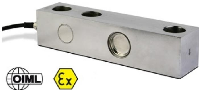
Celle di carico shear beam omologate, con resistenza d'uscita 1000 Ohm a basso consumo per applicazioni mobili a batteria. Indicate per realizzare bilance omologate CE-M a 4 celle oppure per la pesatura di serbatoi e tramogge, grazie agli appositi accessori.
