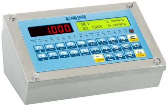
Indicatore di peso digitale a elevate prestazioni, dotato di 3 porte seriali, protocolli di trasmissione per comunicazione dati, stampe completamente configurabili, alibi memory integrata e ingresso per lettore di barcode/badge di serie. L'ampia gamma di accessori e stampanti collegabili garantisce la massima interfacciabilità e versatilità. Omologabile CE-M (OIML R-76 / EN 45501).
