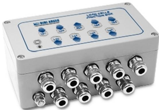
Scatola di giunzione dotata di scheda elettronica per unione ed equalizzazione fino a 8 celle di carico. Particolarmente indicata per pese a ponte, grazie ai Surge Arresters contro scariche elettriche e disturbi. Involucro ideale per ambienti gravosi, con pressacavi metallici e presa di terra. Morsettiere a vite per agevolare il collegamento e trimmer di regolazione del segnale, per una equalizzazione precisa ed affidabile.
